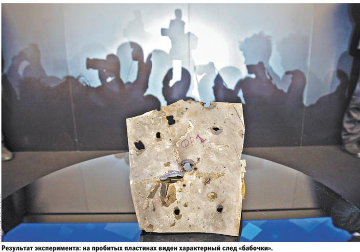
Результат эксперимента: на пробитых пластинах виден характерный след «бабочки».
